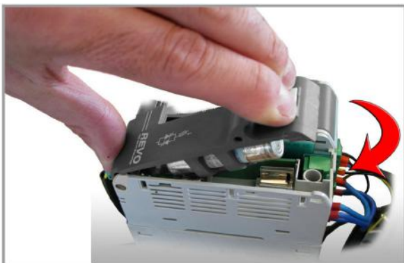
4. Chiudere la copertura premendo
